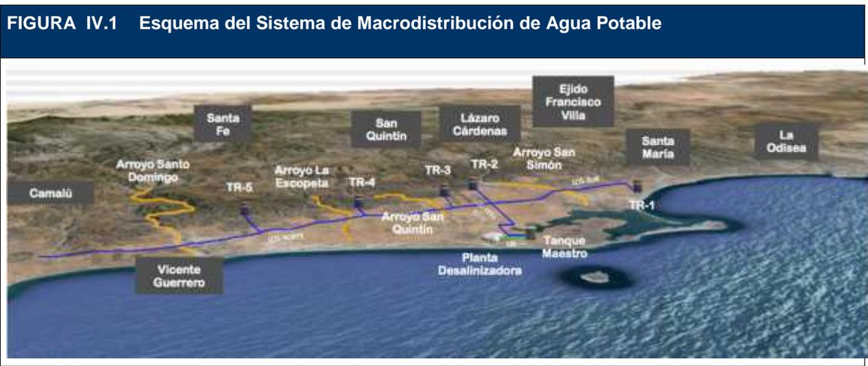
presenta esquemáticamente el modelo de Macrodistribución de Agua Potable y comprende la conectividad hidráulica de todas las localidades desde Santa María en el extremo sur hasta Camalú hacia el norte.
