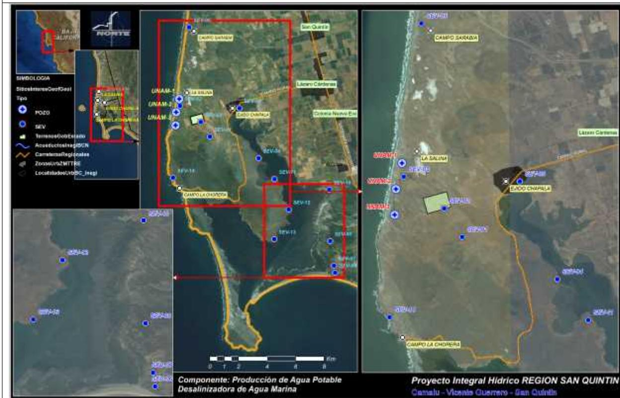
La exploración se realizó en 14 sitios con Sondeos Eléctricos Verticales Schlumberger (SEV) y se tuvo acceso a conocer parcialmente el trabajo realizado de construcción de tres pozos con fines de obtener agua marina. La posición de los sitios en coordenadas UTM WGS 84 para la zona 11 R es la siguiente:
